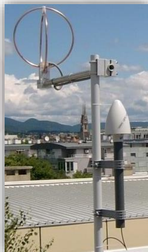
Dva ortogonalna senzorska kruga mjere magnetsku indukciju kao vremensku funkciju u frekvencijskom rasponu (1 kHz – 200 kHz)
